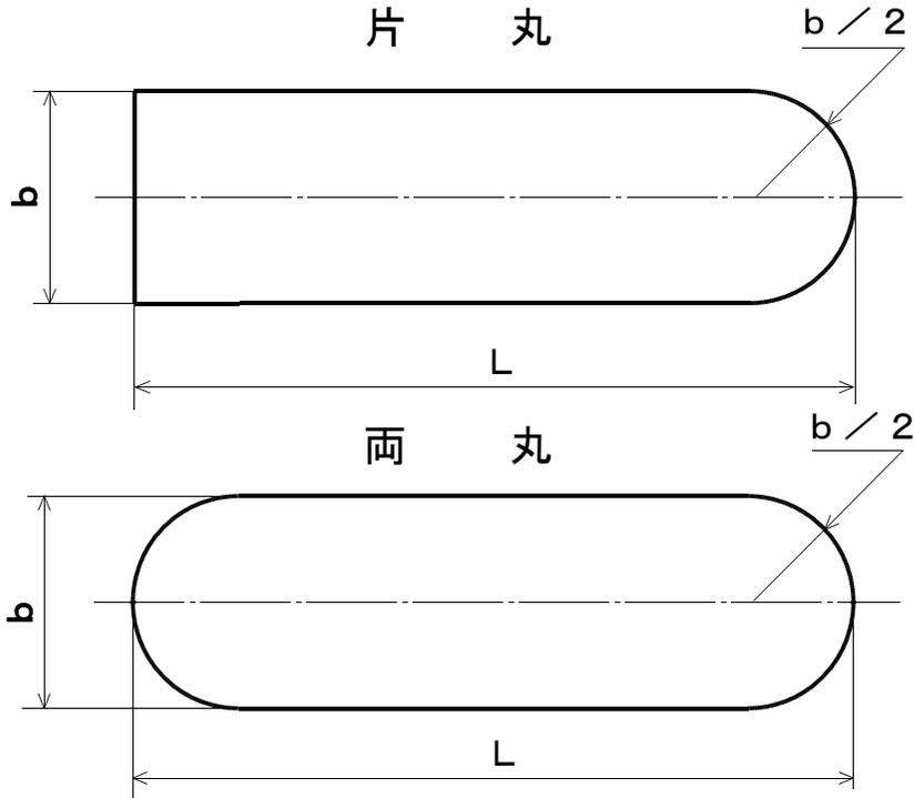
幅、高さ寸法、面取り寸法及び表面粗さ指示は、両角キー図面と同様とする。
